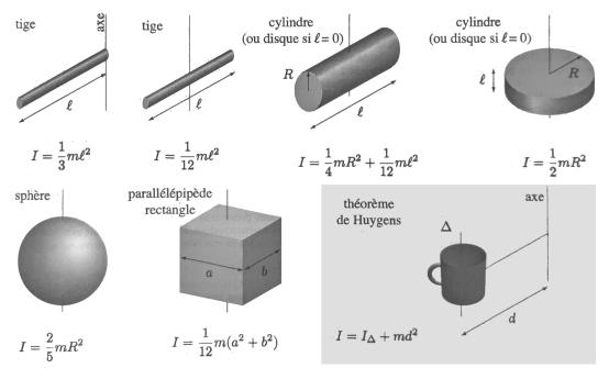
Figure 1 – Valeurs des moments d'inertie I par rapport à un axe de quelques solides homogènes [1]. Dans les expressions, m désigne la masse totale du solide. L'encadré rappelle le théorème de Huygens, donnant la valeur du moment d'inertie I par rapport à l'axe indiqué en fonction de  $I_{\Delta}$ , celui passant par le centre d'inertie du solide.
